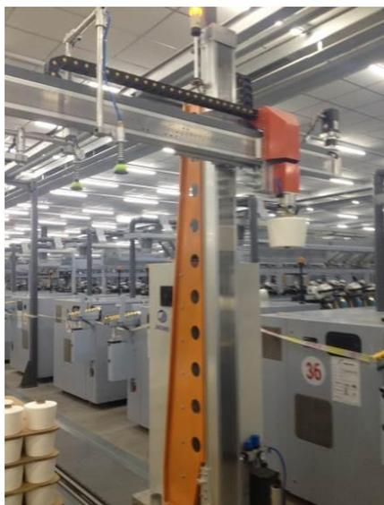
筒纱码垛机器人系统
